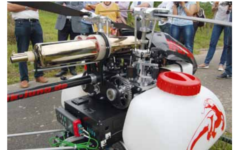
Blick auf die robusten Getriebegehäuse und die beiden Edelstahl-Schalldämpfer des Waran-Flettner-Helis. Der Boxermotor ist frontseitig angeordnet
