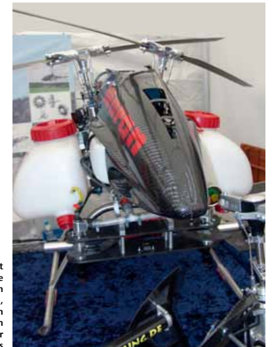
Blick auf die robusten Getriebegehäuse und die beiden Edelstahl-Schalldämpfer des Waran-Flettner-Helis. Der Boxermotor ist frontseitig angeordnet
