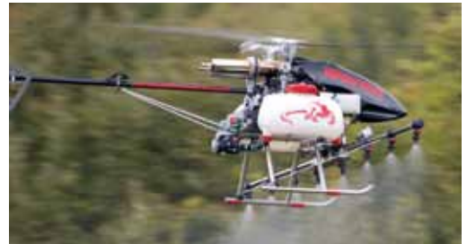
Leise und effizient – Waran in geringer Höhe über den Weinbergstöcken. Derzeit wird der Hubschrauber noch konventionell gesteuert. Zukünftig soll eine automatische Steuerung die Arbeit des Piloten erleichtern
